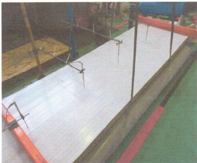
Общий вид панели МП ТСП К 100×3500 под нагрузкой.
