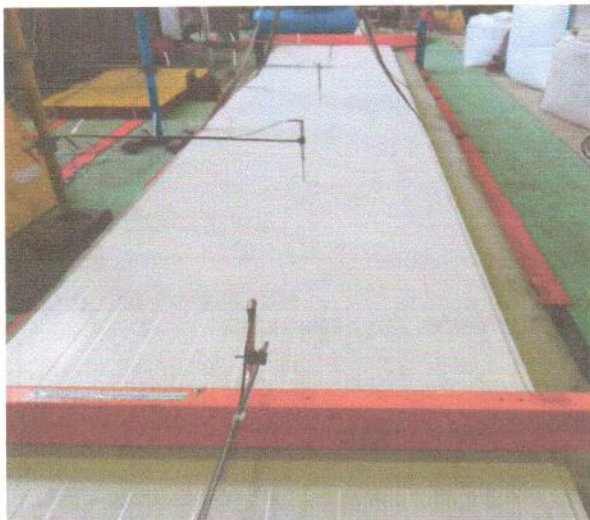
Общий вид панели МП ТСП Z 100×6000 под нагрузкой.
