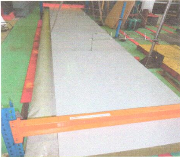
Общий вид панели МП ТСП Z 150×6000 под нагрузкой.
