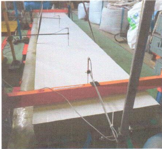
Общий вид панели МП ТСП К 150×6000 под нагрузкой.
