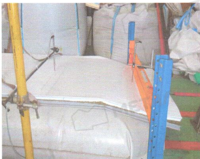
Разрушение образца №1 панели.
