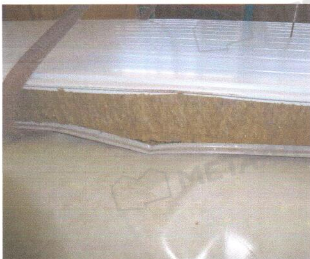
Разрушение образца №1 панели.
