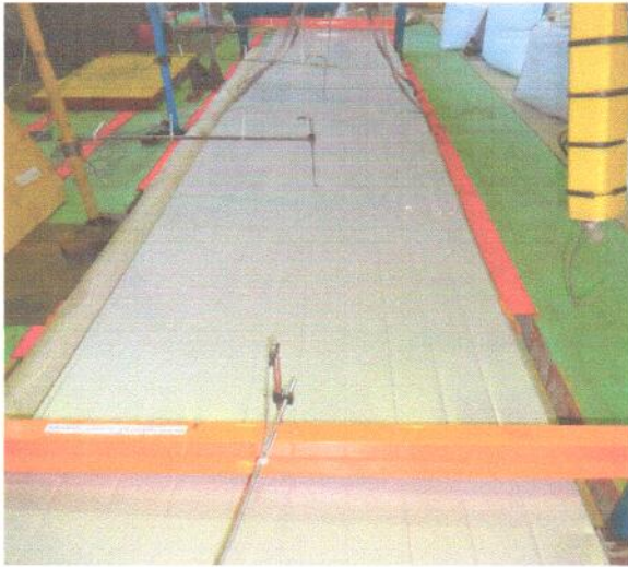
Общий вид панели МП ТСП К 200×6000 под нагрузкой.
